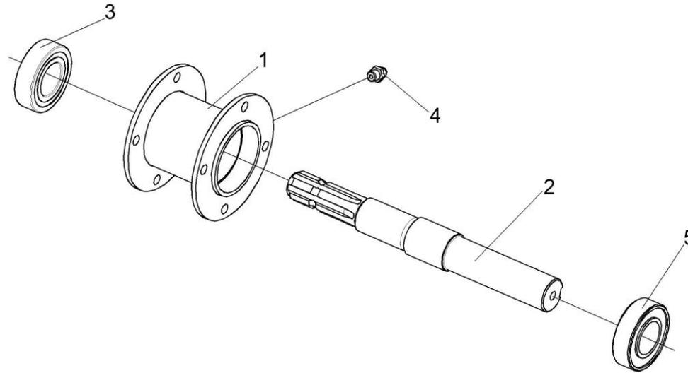
Рисунок 23 – Контрпривод 1.320.193
