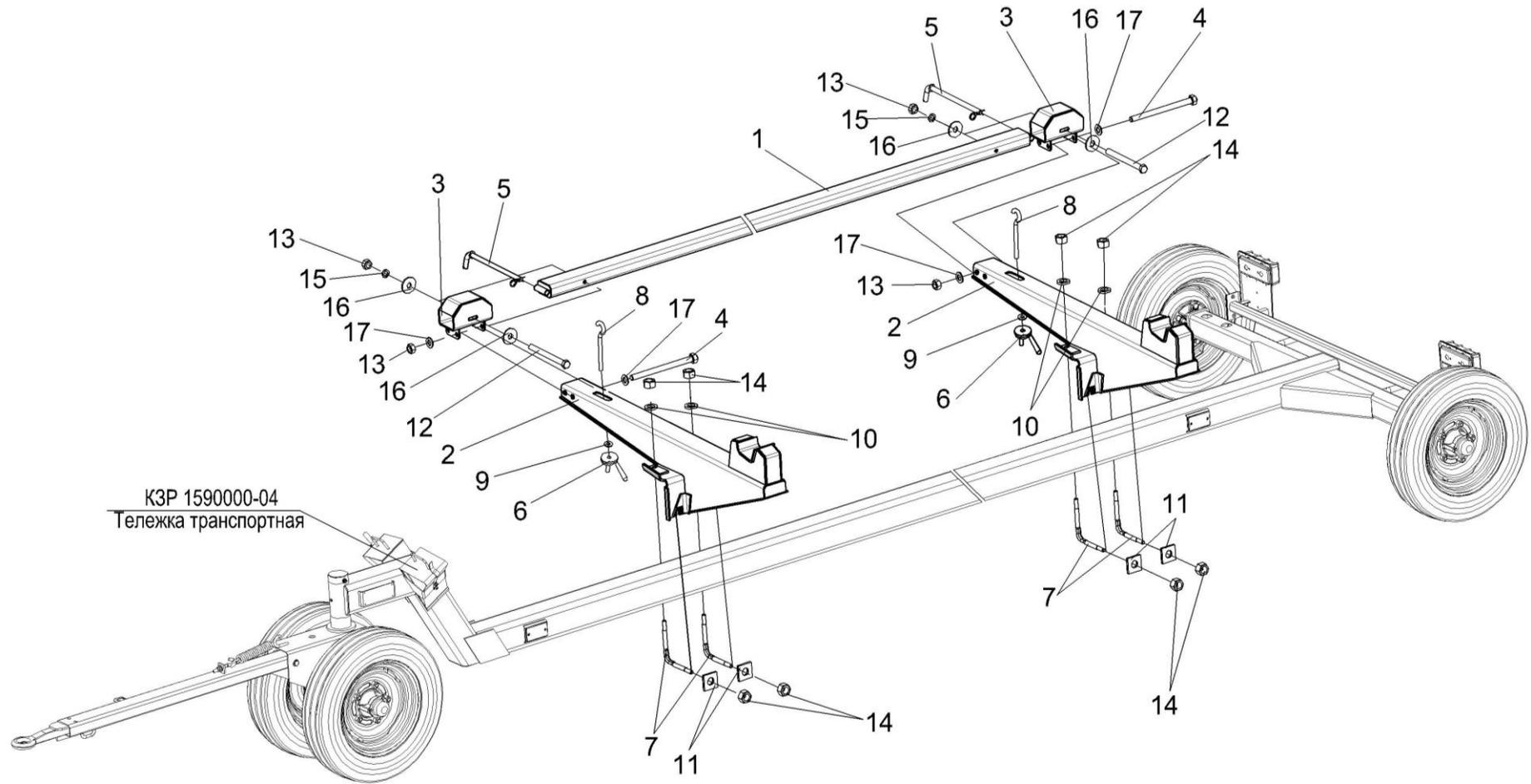
Рисунок 48 – Установка монтажных изделий на тележку транспортную
