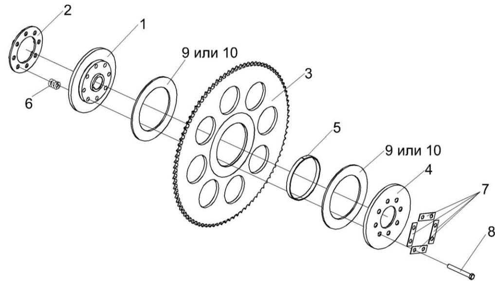
Рисунок 22 – Муфта предохранительная 1.314.166
