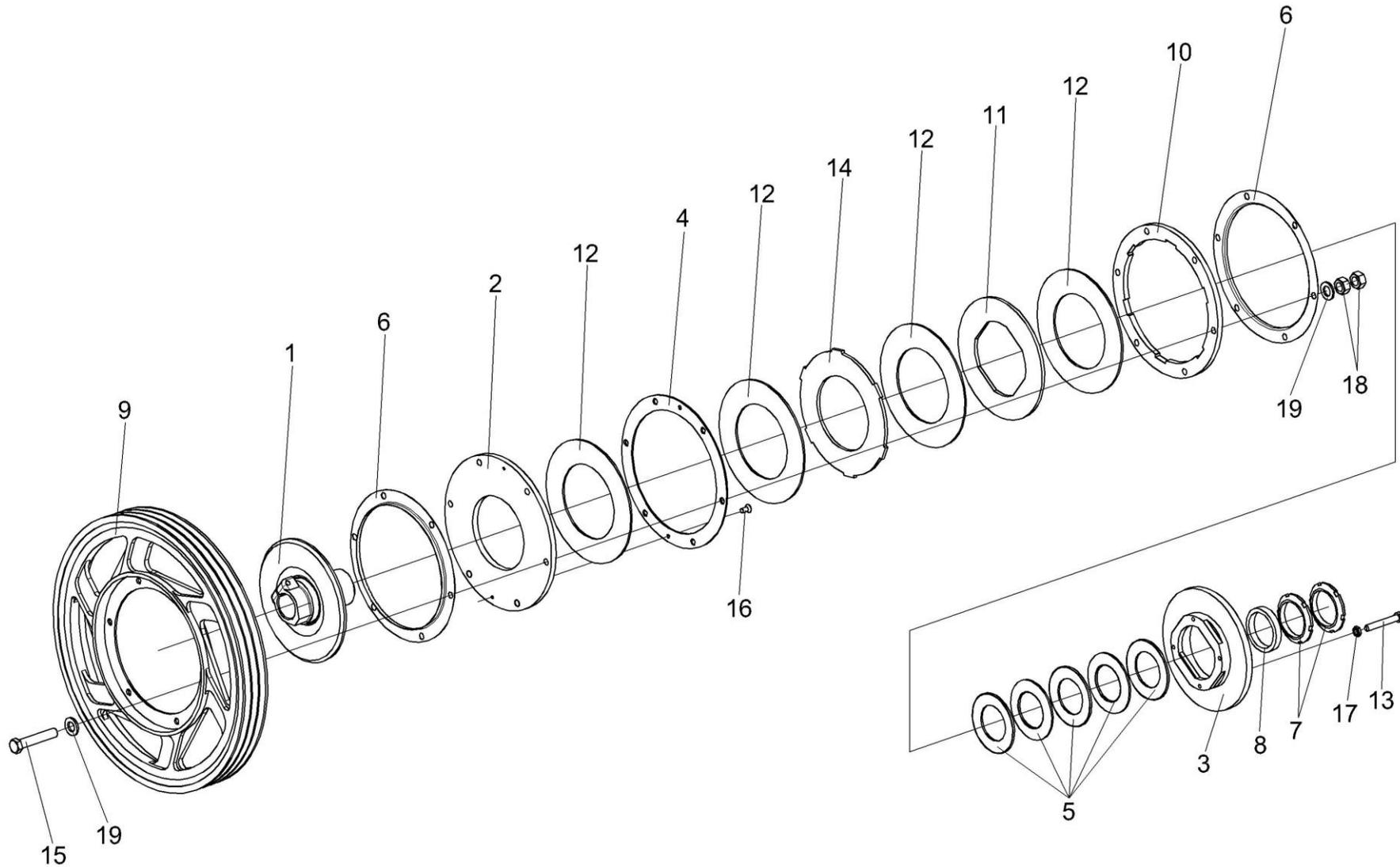
Рисунок 3 – Муфта предохранительная КЗК-12-1-0502090
