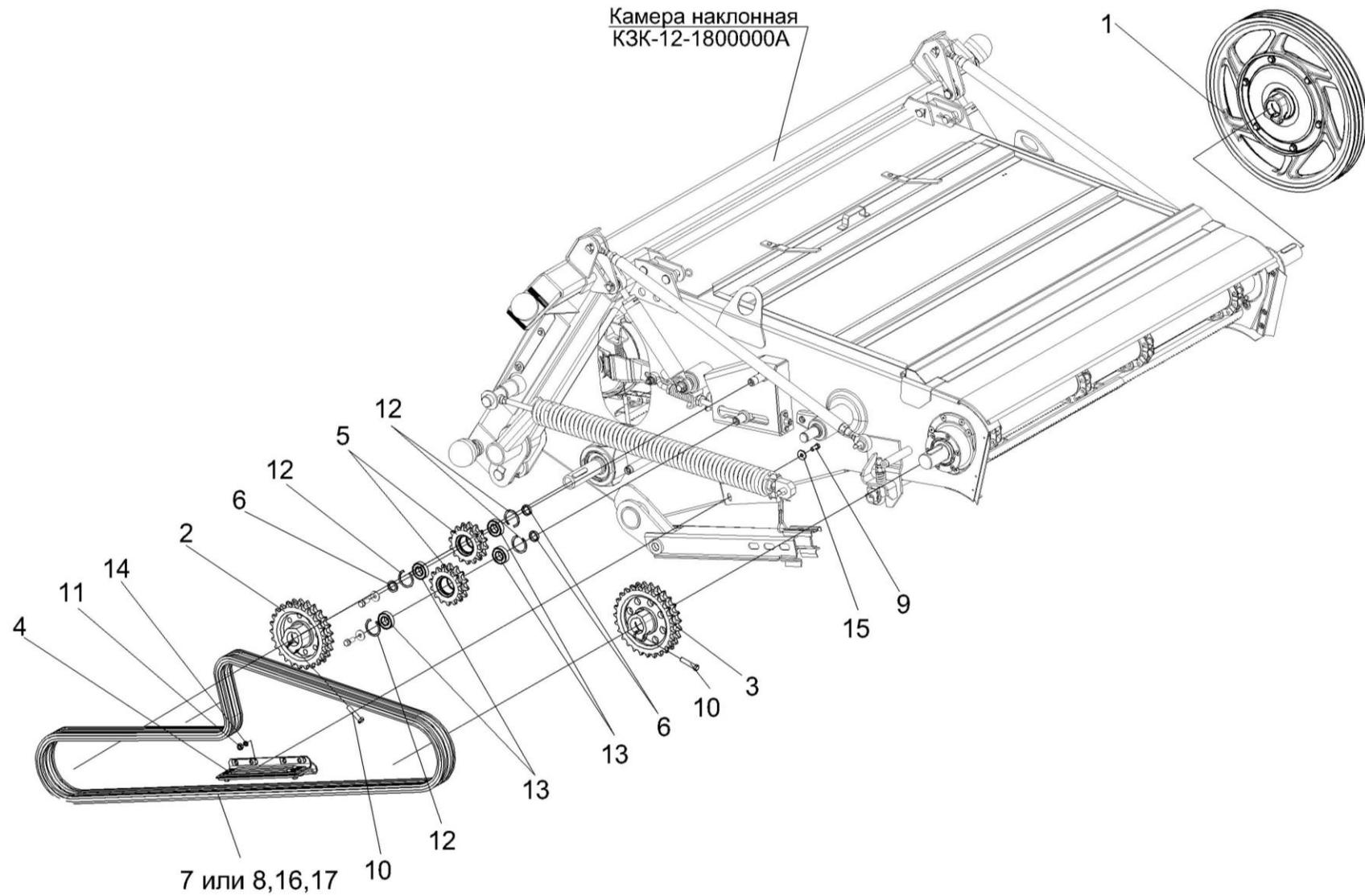
Рисунок 2 – Установка монтажных изделий на камеру наклонную
