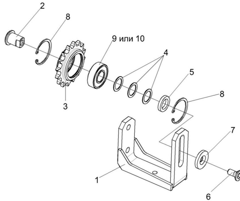
Рисунок 24 – Устройство натяжное 1.320.243
