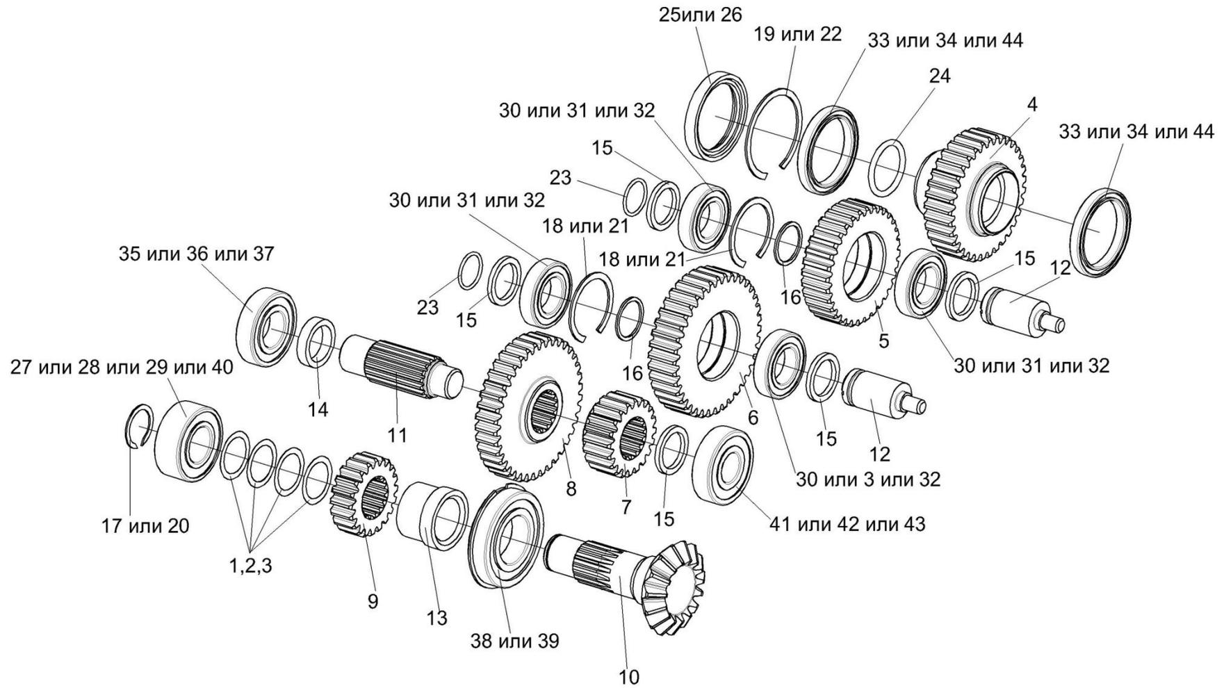
Рисунок 46 – Мультипликатор КПС-4-0517100 (валы, шестерни)
