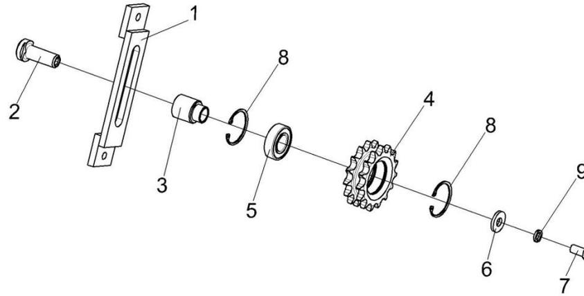
Рисунок 28 –Устройство натяжное 1.322.209
