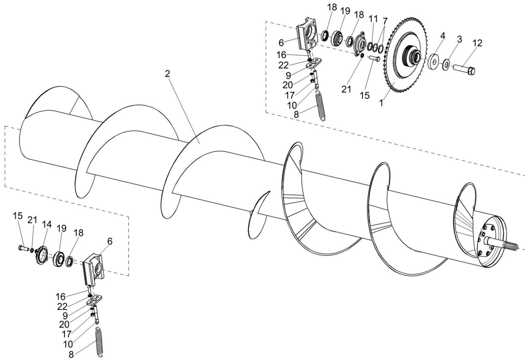
Рисунок 4 – Подборщик КГС 0900000 (установка шнека и муфты фрикционной)
