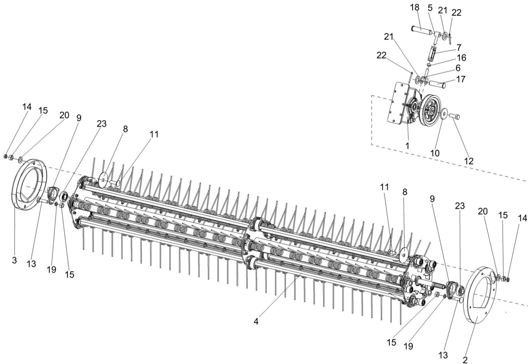
Рисунок 3 – Подборщик КГС 0900000 (установка устройства подбирающего)
