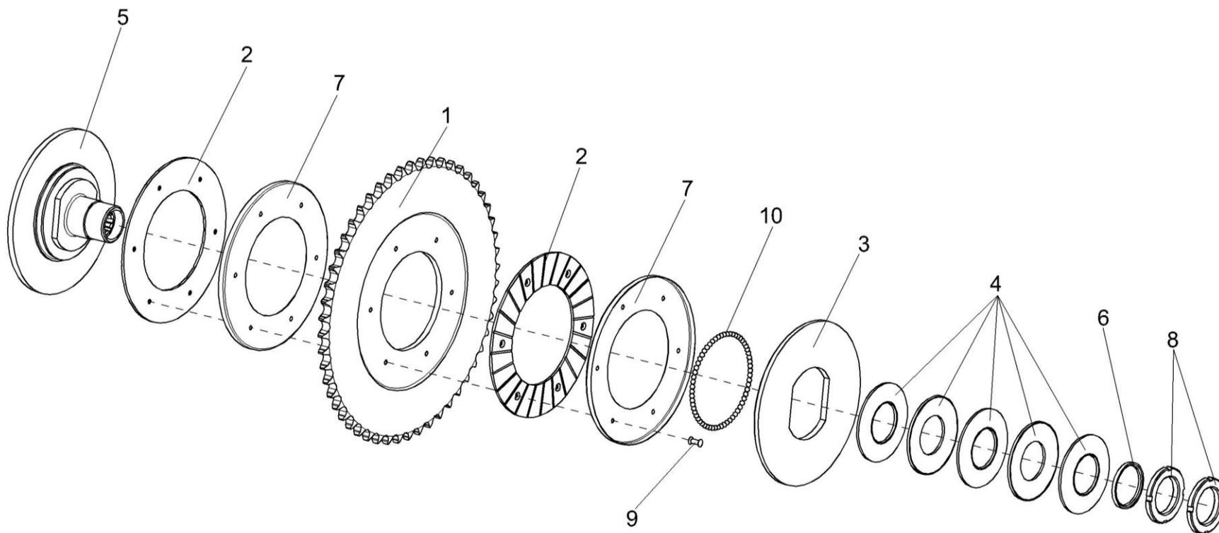
Рисунок 7 – Муфта фрикционная КГС 0900010
