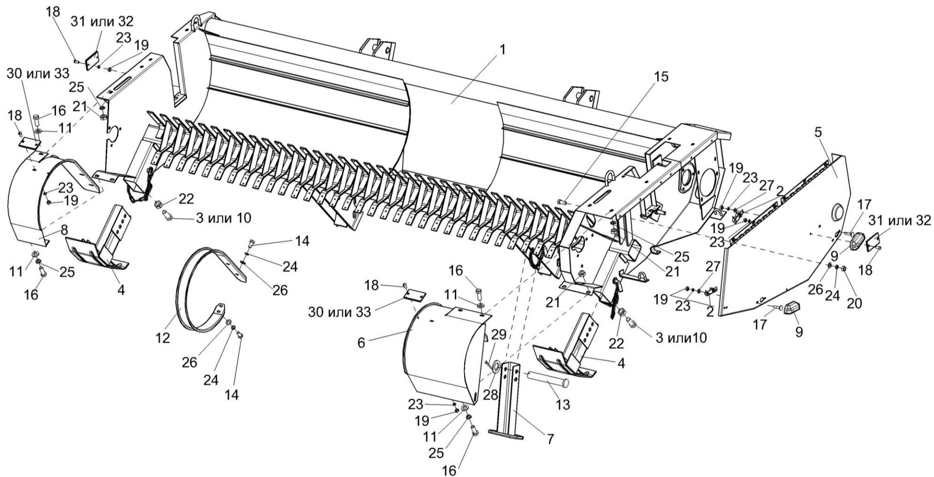
Рисунок 2 – Подборщик КГС 0900000 (установка щитка, скатов, башмаков, стойки)
