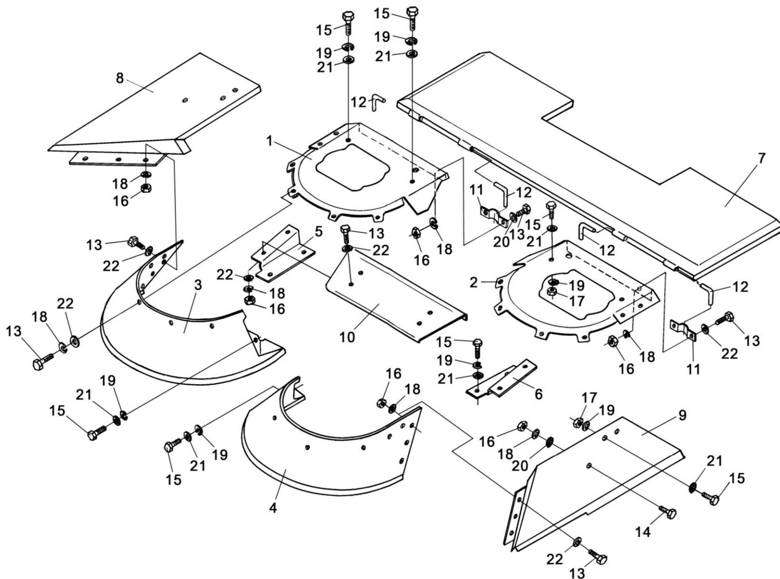
Рисунок 5 – Панели, кожух и боковина жатки
