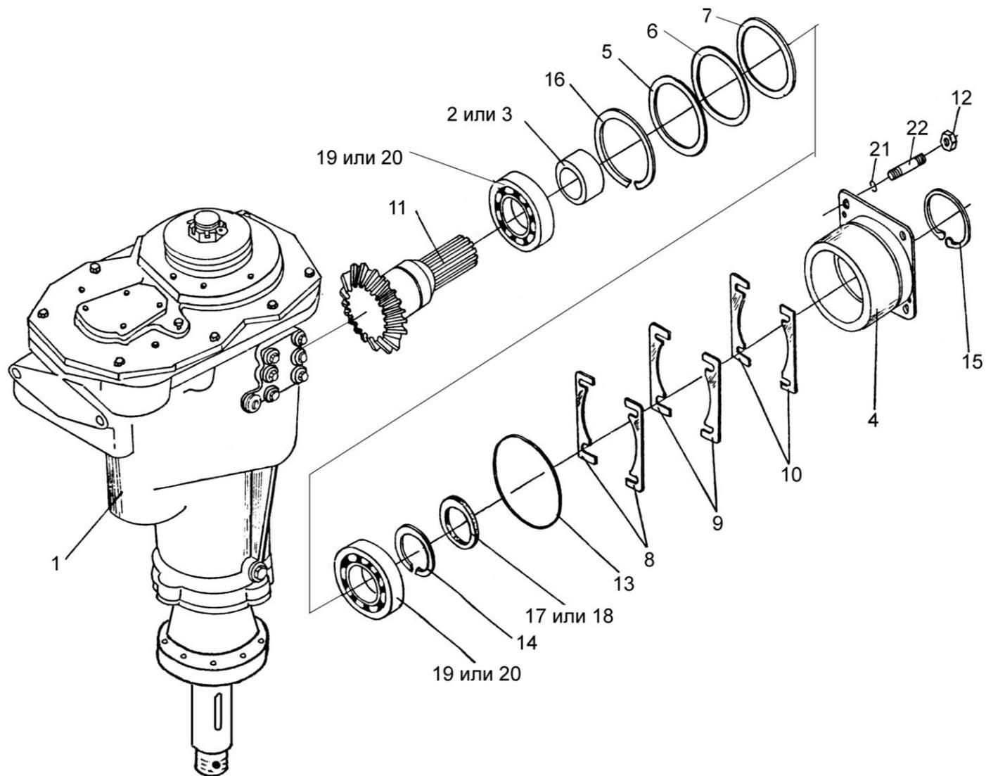
Рисунок 12 – Редуктор конический ПКК 0202850-02
