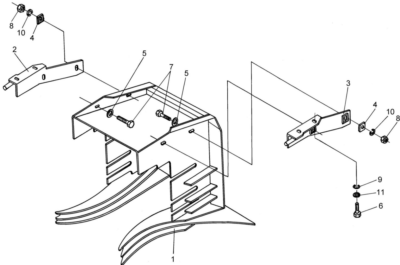
Рисунок 6 – Кожух скребка ПКК 0204030, державка ПКК 0204040 и ПКК0204040-01
