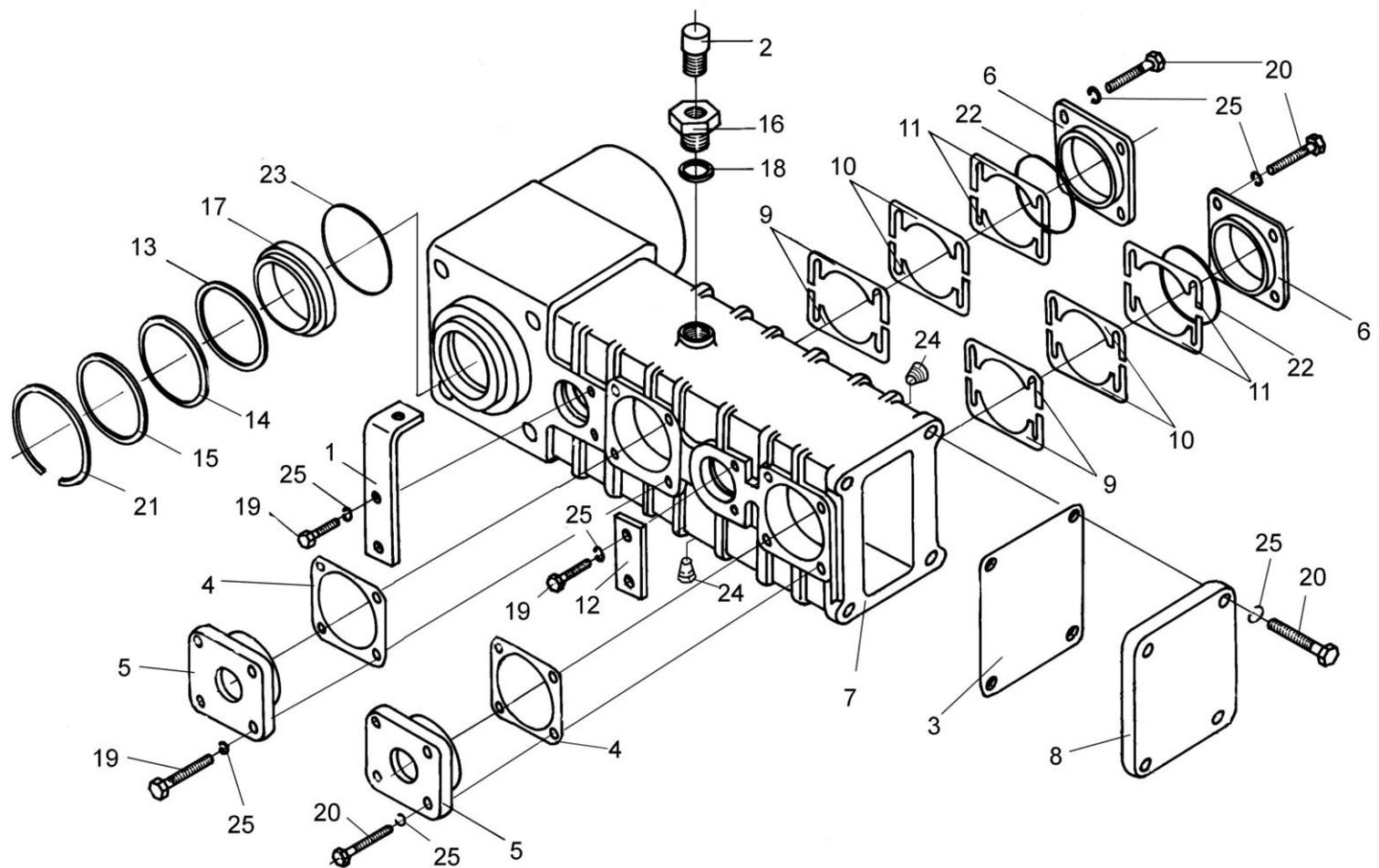
Рисунок 15 – Редуктор цилиндрический ПКК 0202890 (корпус и крышки)
