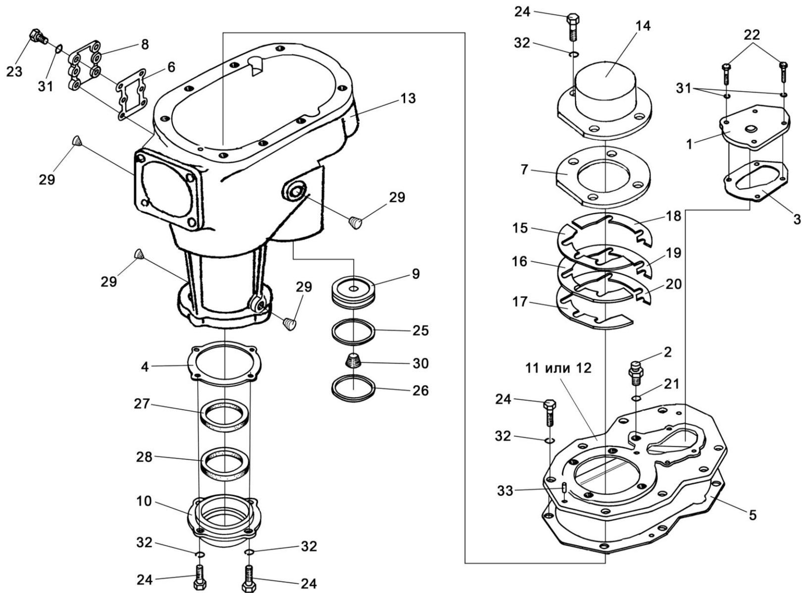
Рисунок 13 – Редуктор ПКК 0202860-02 (корпус и крышки)
