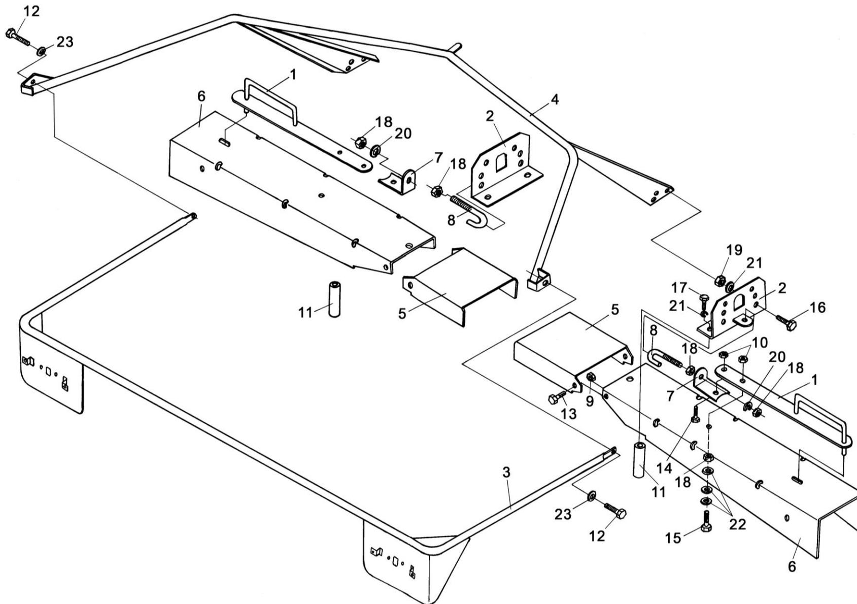
Рисунок 4 – Брус заламывающий ПКК 0205030, ограждение ременной передачи
