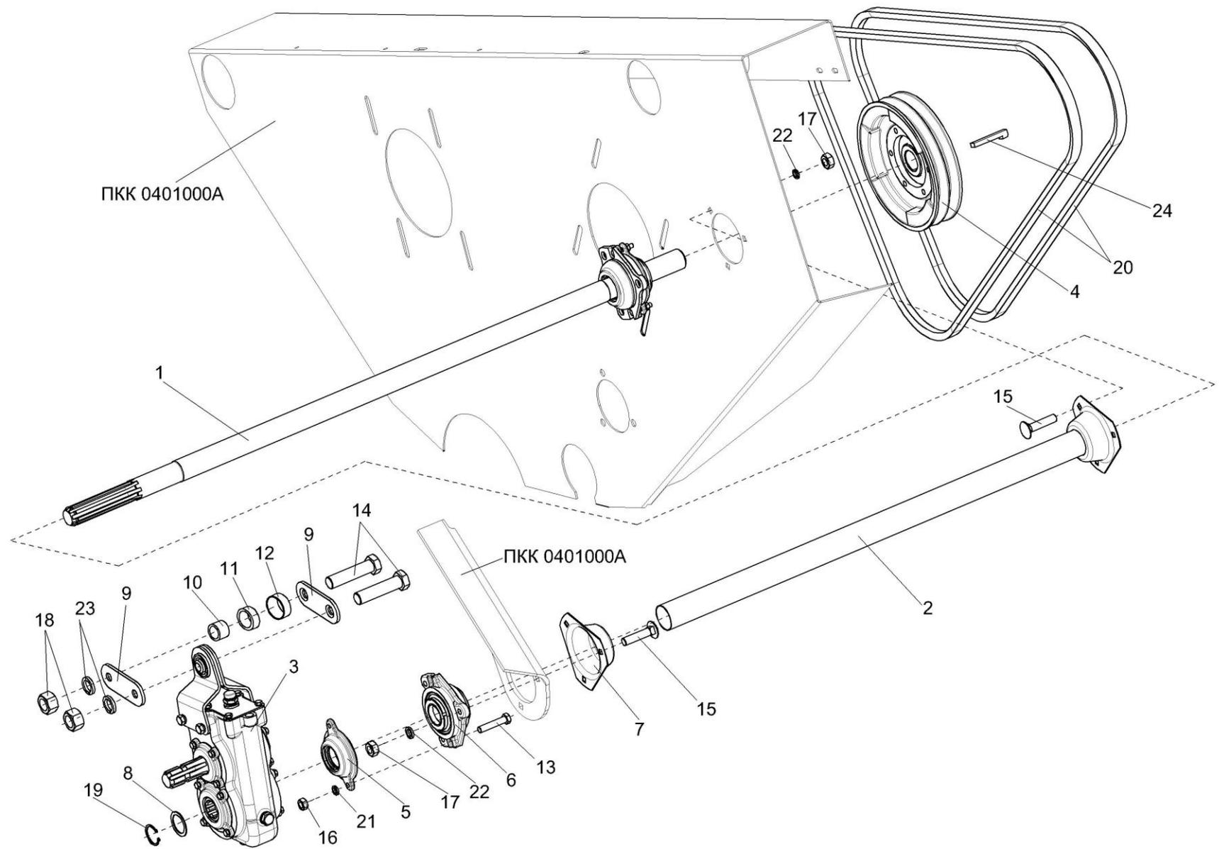
Рисунок 6 – Установка контрпривода ППК 0403000А
