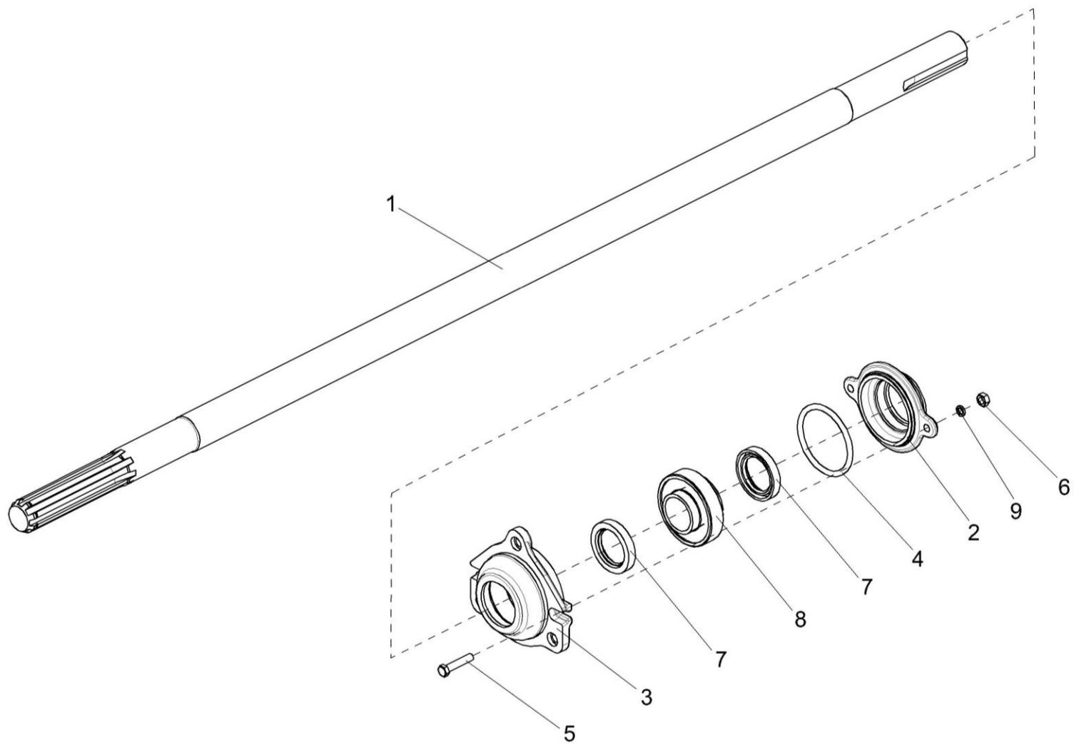
Рисунок 7 – Контрпривод ПКК 0403000А
