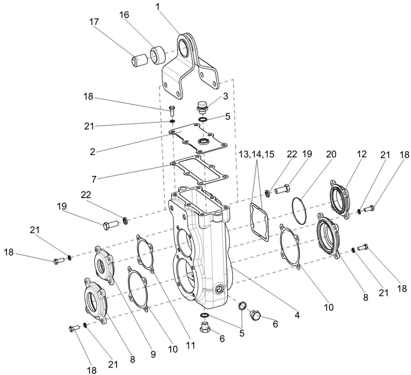
Рисунок 8 – Редуктор ПКК 0409000 (корпус и крышки)
