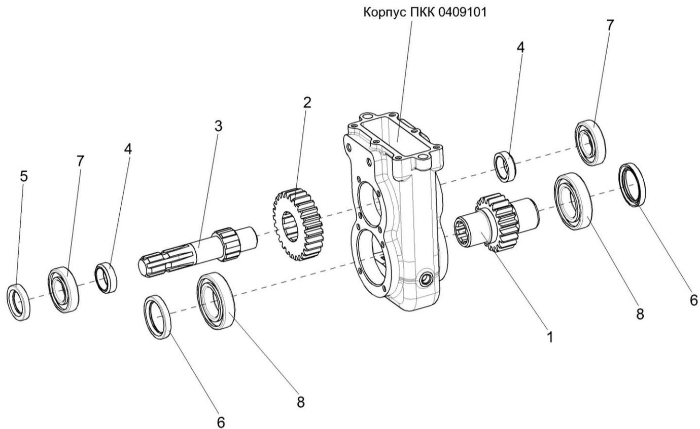
Рисунок 9 – Редуктор ПКК 0409000 (валы и шестерни)
