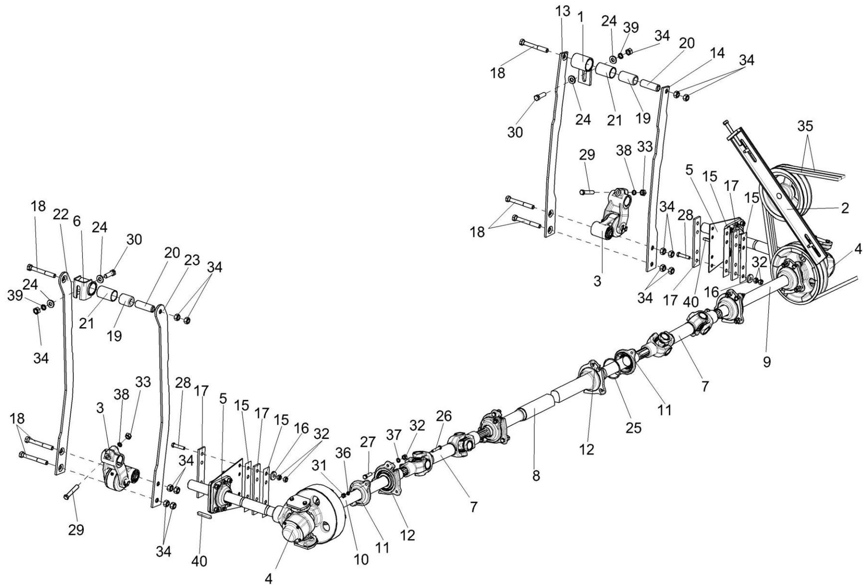
Рисунок 21 – Привод жатки
